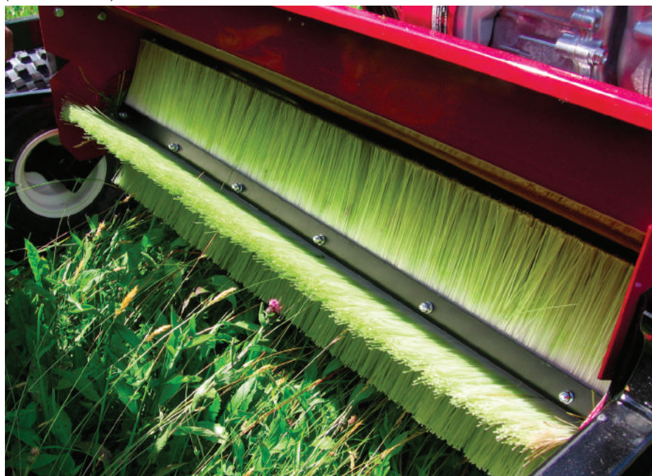
▼ Fig. 11 - Particolare della spazzola per la raccolta del fiorume in una spazzolatrice trainata (foto A. Ferrario)
