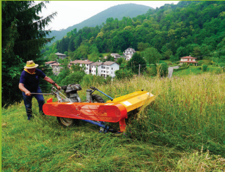
▼ Fig. 12 -Prototipo di spazzolatrice in kit per motofalciatrice, durante una prova eseguita dal suo ideatore, Dott. Andrea Messa (foto A. Ferrario)
