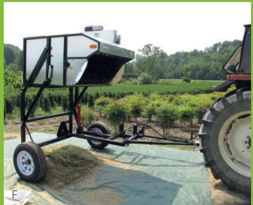
A: macchina completa pronta all'uso; B: dettaglio della spazzola rotante brevettata, con setole in nylon industriale; C e D: viste anteriore e posteriore della macchina durante la raccolta; E: apertura del cassone per lo scarico del fiorume; F: macchina in posizione di massima altezza di spazzolamento. Foto di A. Ferrario.
